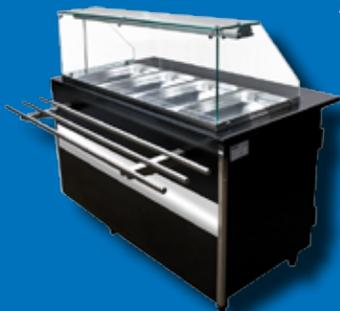
Außengehäuse schwarz pulverbeschichtet, Frontverkleidung aus schwarzem Laminat, Granitarbeitsplatte grau 30 mm, gerade Frontscheibe, Beleuchtung, Thermostat, Kapazität: 2 x GN 1/1 + 1 x GN 2/4, Temperaturbereich: +30°/+90°C, Anschlussw.: 230 V / 1614 W, Abm.: 100 x 80 x 125 cm (BxTxH)
