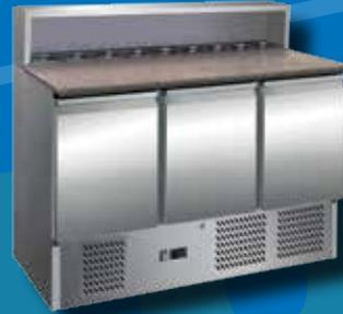
innen und außen komplett aus Edelstahl, steckerfertig, Umluftkühlung, autom. Abtaung, eingeschäumter Verdampfer, Temperaturregelung über digitales Display, geeignet für 8 x GN 1/6, Tiefe max. 150, höhenverstellbare Füße, mit 3 Türen und Edelstahlauflauf, Kapazität: 400 lt., Temperatur: +2°C/+8°C, Anschlussw.: 230 V / 350 W, Abm.: 136,8 x 70 x 109 cm (BxTxH)
