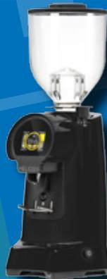
Farbe: Mattschwarz, Dosierung On Demand, mit Touchscreen-Display, mit 3 Dosierprogrammen und manueller Dosierung, Dosierzählwerk und Beleuchtung des Siebträgers, mikrometrische und stufenlose Einstellung des Mahlgrades, mit flacher Mahlscheibe aus gehärtetem Stahl, DM: 6,5 cm, höhenverstellbarer Auslauf und Sicherheitssensor des Bohnenbehälters, Behälter für Kaffeebohnen: 1,2 kg, Mahlggeschwindigkeit: 3,5 - 5 g/s, Motor: 1370 rpm, Anschlussw.: 230 V / 280 W, Abm.: 22 x 25 x 60 cm (BxTxH)
