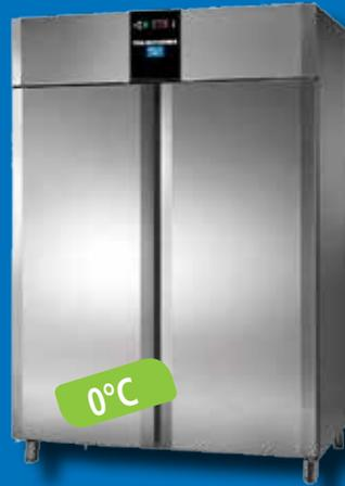
aus Edelstahl, Umluftkühlung, autom. Abtauung, Isolierstärke: 60 mm, elektronische Steuerung, höhenverstellbare Edelstahlfüße, 2 Edelstahltüren mit Stärke 6 cm, inkl. 6 Roste GN 2/1, Tragkraft/Rost: 30 kg, Fassungsvermögen: 1400 lt., Temperaturbereich: -2°/+8°C, Kältemittel: R455, Anschlussw.: 230 V / 570 W, Abm.: 142 x 80 x 203,5/210,5 cm (BxTxH)
