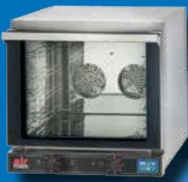
Innenraum, Backblechträger, Oberseite und sichtbare Bestandteile aus Edelstahl, einheitliche Zubereitung von verschiedensten Speisen, einfache Bedienung, energiesparend, temperierte Glasür mit niedrigem Emissionsgrad nach innen, Sicherheitsgriff, Füße rutschfest, Innenbeleuchtung, mechanische Steuerung, doppelter Ventilator, Kapazität: 4 Roste je 43,5 x 35 cm, Schienenabstand: 8,4 cm, Anschlussw.: 230 V / 3,35 kW, Abm. Backraum: 46,4 x 42 x 37 cm (BxTxH), Abm.: 58,9 x 66 x 58 cm (BxTxH)
