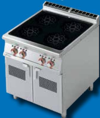
2 mm starke Oberplatte, IPX5-spritzwassergeschützt, Schweizer Induktionstechnologie von EGO, 4 Kochfelder je 5 kW, geeignet für Töpfe ab 16 cm DM, Unterbau mit Flügeltüren geschlossen, Anschlussw.: 400 V / 20 kW, Abm.: 80 x **70,5** x 90 cm (BxTxH)
