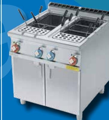
2 mm starke Oberplatte, IPX5-spritzwassergeschützt, 2 Becken je 30,7 x 50,9 x 32,7 cm (BxTxH), Wasserlaufbahn, Überlaufvorrichtung, Ablauf am Boden, ohne Körbe, Kapazität: 80 lt., Anschlussw.: 400 V / 27 kW, Abm.: 80 x 90 x 90 cm (BxTxH)
