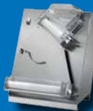
perfekt zum Ausrollen von Pizza-, Brot- und Fladenteig geeignet, Gehäuse vollständig aus Edelstahl, Durchmesser und Teigdicke regulierbar, obere Walze geneigt, Walzenlänge: 42 cm, Anschlusswert: 230 V / 370 W, Abm.: 59 x 54 x 76/82 cm (BxTxH)
