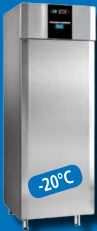
aus Edelstahl, Umluftkühlung, autom. Abtauung, Isolierstärke: 60 mm, elektronische Steuerung, 1 Edelstahltür mit Stärke 6 cm, Türanschlag wechselbar, inkl. 3 Roste GN 2/1, Tragkraft/Rost: 30 kg, Fassungsvermögen: 700 lt., Temperaturbereich: -18°/-22°C, Kältemittel: R455, Anschlussw.: 230 V / 650 W, Abm.: 71 x 80 x 203,5/210,5 cm (BxTxH)
