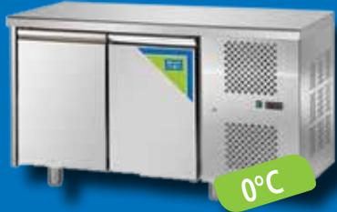
aus Edelstahl, elektronische Steuerung, Umluftkühlung, automat. Abtauung, höhenverstellbare Edelstahlfüße, inkl. 2 Edelstahltüren, pro Tür je 1 Rost GN 1/1 mit 2 L-Schienen, Fassungsvermögen: 320 Lt., Temperaturbereich: 0°/+10°C, Kältemittel: R452a, Anschlussw.: 230 V / 495 W, Abm.: 142 x 70 x 90 cm (BxTxH)
