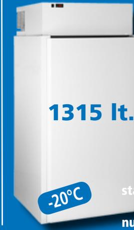
Weiß, steckerfertige Umluftkühlung, digitale Temperaturanzeige, automatische Tauwasserverdunstung, Isolierstärke: 60 mm, Edelstahlboden und selbstschließende Türe mit Öffnungslichte 70 x 168 cm, 3 Regalböden 88 x 49 cm, Fassungsvermögen: 1315 lt., Temperaturbereich: -18°/-20°C, Kältemittel: R452a, Anschlussw.: 230 V / 700 W, Innen Abm.: 88 x 88 x 170 cm (BxTxH), Außen Abm.: 100 x 100 x 212 cm (BxTxH)
