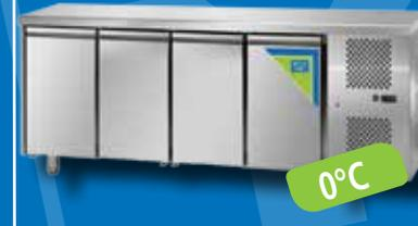
aus Edelstahl, elektronische Steuerung, Umluftkühlung, automat. Abtauung, höhenverstellb. Edelstahlfüße, inkl. 4 Edelstahltüren, Fassungsvermögen: 630 Lt., Temperaturbereich: 0°/+10°C, Kältemittel: R452a, Anschlussw.: 230 V / 495 W, Abm.: 232 x 70 x 90 cm (BxTxH)
