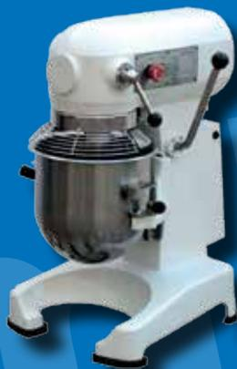
massives Metallgehäuse, Gitterschutz, abnehmbare Edelstahl-Rührschüssel, Kapazität (trockenes Mehl): bis 3 kg, Kesselvolumen: 10 lt., 3 Geschwindigkeiten: 125-225-404 U/Min., Anschlussw.: 230 V / 0,4 kW, Abm.: 40 x 53 x 70 cm (BxTxH)
