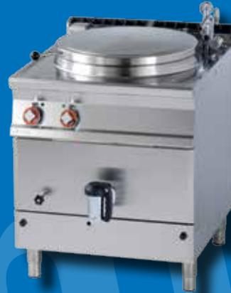
2 mm starke Oberplatte, IPX5-spritzwassergeschützt, indirekt beheizt, Kapazität: 100 lt., Becken: 60 x 42 cm (DMxH), Anschlussw.: 400 V / 16 kW, Abm.: 80 x 90 x 90 cm (BxTxH)
