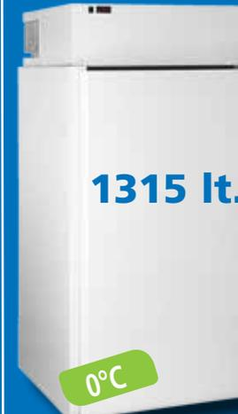
Weiß, steckerfertige Umluftkühlung, digitale Temperaturanzeige, automatische Tauwasserverdunstung, Isolierstärke: 60 mm, Edelstahlboden und selbstschließende Türe mit Öffnungslichte 70 x 168 cm, 3 Regalböden 88 x 49 cm, Fassungsvermögen: 1315 lt., Temperaturbereich: 0°/+8°C, Kältemittel: R452a, Anschlussw.: 230 V / 570 W, Innen Abm.: 88 x 88 x 170 cm (BxTxH), Außen Abm.: 100 x 100 x 212 cm (BxTxH)
