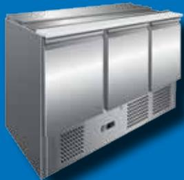
innen und außen komplett aus Edelstahl, steckerfertig, Umluftkühlung, autom. Abtaung, Kapazität: 400 lt., eingeschäumter Verdampfer, Temperaturregelung über digitales Display, höhenverstellbare Füße, Schiebe/Klappdeckel, inkl. Polyäthylenschneidbrett, 3 höhenverstellbare Roste GN 1/1, geeignet für 4 x GN 1/1, Isolierstärke: 45 mm, Temperaturbereich: +2°C/+8°C, Anschlussw.: 230 V / 230 W, Abm.: 136,5 x 70 x 87 cm (BxTxH)
