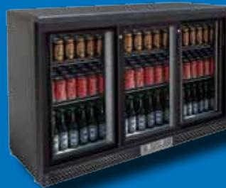
Mit 3 Glasschiebetüren, Kapazität: 381 lt., inkl. 3 Ablagen, Umluftkühlung, digitale Temperaturregelung, Temperaturbereich: +3°/+10°C, Anschlussw.: 230 V / 315 W, Abm.: 135 x 53,5 x 92,5 cm (BxTxH)
