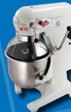
massives Metallgehäuse, Gitterschutz, abnehmbare Edelstahl-Rührschüssel, Kapazität (trockenes Mehl): bis 6 kg, Kesselvolumen: 20 lt., 3 Geschwindigkeiten: 125-225-404 U/Min., Anschlussw.: 380 V / 0,75 kW, Abm.: 41,5 x 53 x 75 cm (BxTxH)
