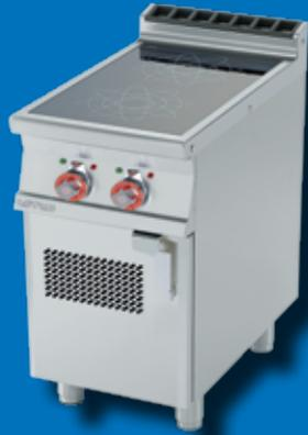
2 mm starke Oberplatte, IPX5-spritzwassergeschützt, Schweizer Induktionstechnologie von EGO, 2 Kochfelder je 5 kW, geeignet für Töpfe ab 16 cm DM, Unterbau geschlossen, Anschlussw.: 400 V / 10 kW, Abm.: 40 x **70,5** x 90 cm (BxTxH)
