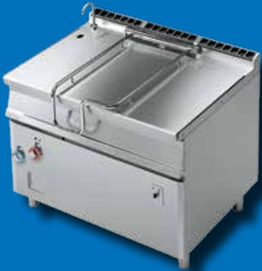
2 mm starke Oberplatte, IPX5-spritzwassergeschützt, automat. Kippung, Kapazität: 120 lt., Edelstahlbecken mit Boden aus Edelstahl, inkl. Deckel, Anschlussw.: 400 V / 18,1 kW, Abm.: 120 x 90 x 90 cm (BxTxH)
