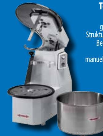
geeignet für verschiedene Teigtypen, Struktur mit kratzfestem Lack beschichtet, Behälter, Spirale und Teigknetstab aus Edelstahl, Sicherheitsmikroschalter, manuelle Kopfanhebung und ausziehbarer Kessel, mit Sicherheitssensor, Kapazität: 38 kg / 42 lt., Stundenleistung: ca. 114 kg, Anschlussw.: 400 V / 1500 W, Abm.: 48 x 80 x 73 cm (BxTxH)
